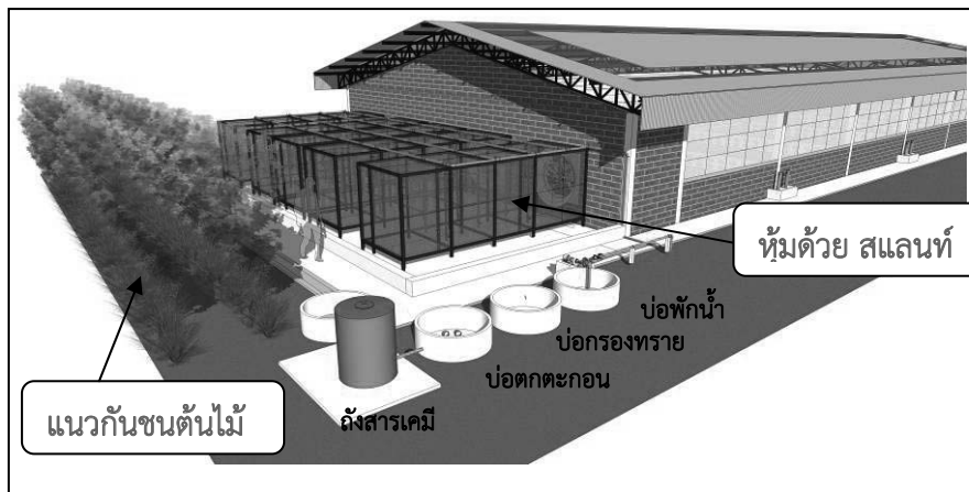
รูปที่ 7.3-8 ม่านกระจายน้ำกำจัดกลิ่นหลังพัสดลมโรงเรือน
